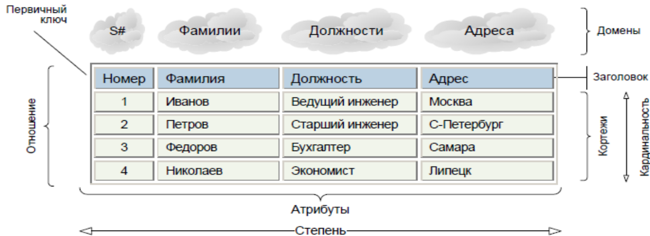
Рис. 2.1. Наглядное представление основных понятий реляционной модели
