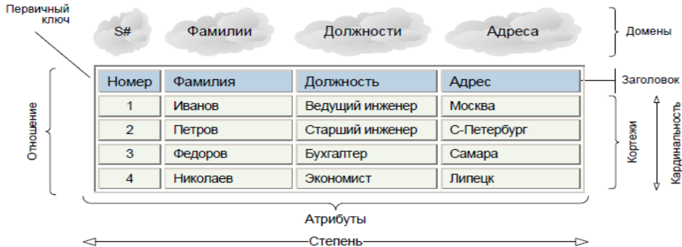
Рис. 2.1. Наглядное представление основных понятий реляционной модели
